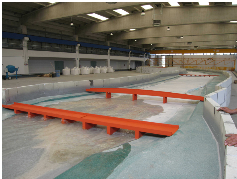
Fig. 1 Il modello fisico all'interno del laboratorio (visto da monte) – esperimenti a fondo fisso
