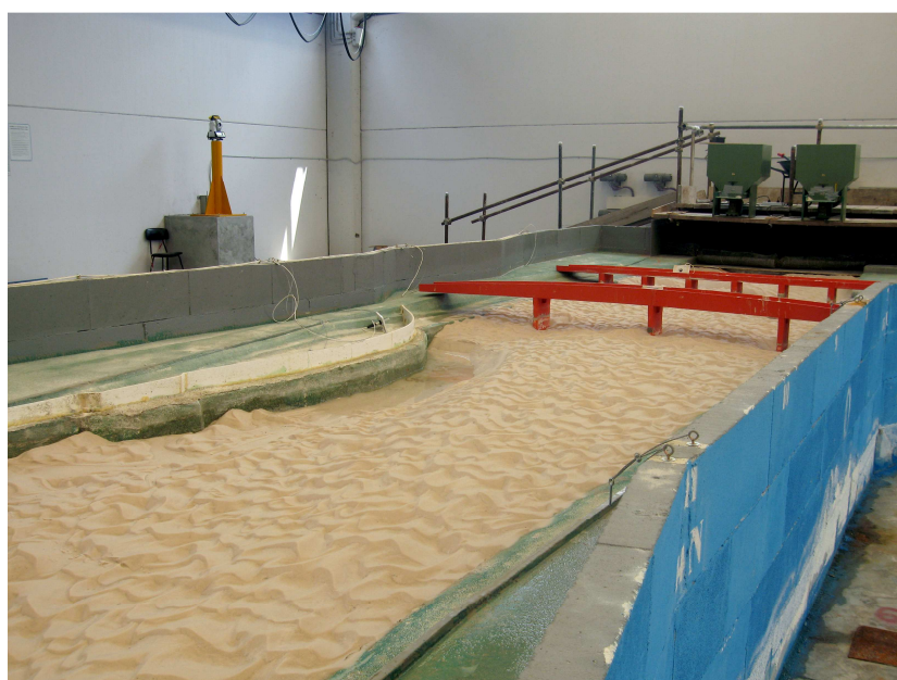
Fig. 2 Particolare del modello fisico (visto da monte) – esperimenti a fondo mobile
